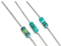
Un élément résistif est un composant constitué de matériau ayant une forte résistivité. Il s'oppose au passage du courant dans un circuit électrique. On l'utilisera donc en général pour limiter l'intensité du courant dans un circuit.
