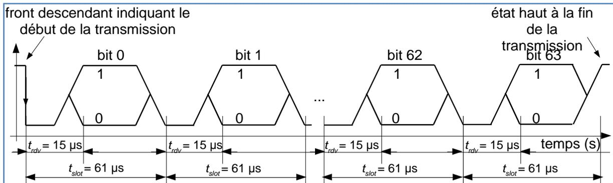
**Q3.** Pour établir la communication avec les puces DS2401, **indiquer** la fréquence de transmission des bits à renseigner dans la centrale d'acquisition. La centrale d'acquisition règle alors l'instant de lecture au milieu du bit transmis par la puce DS2401, **expliquer** pourquoi ce choix convient.
