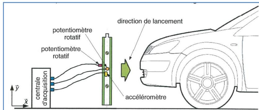
de l'adapter à la plage d'entrée du convertisseur analogique numérique, comprise entre -5 V et +5 V, et d'augmenter la précision du signal numérisé. L'objectif est donc de déterminer la valeur du gain à régler avant de réaliser les mesures.
