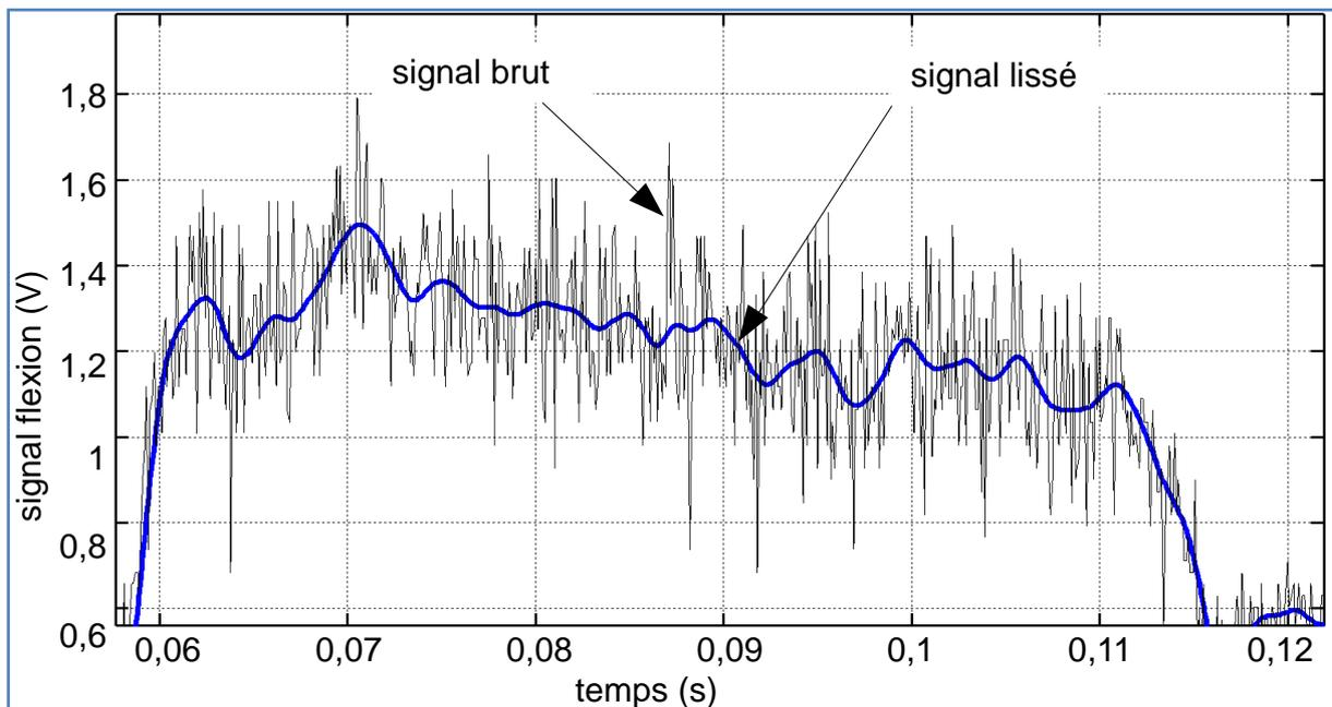
**Q5.** En comparant le signal brut et le signal lissé, **indiquer** et **justifier** le type de filtre à utiliser, parmi les deux proposés ci-contre:
