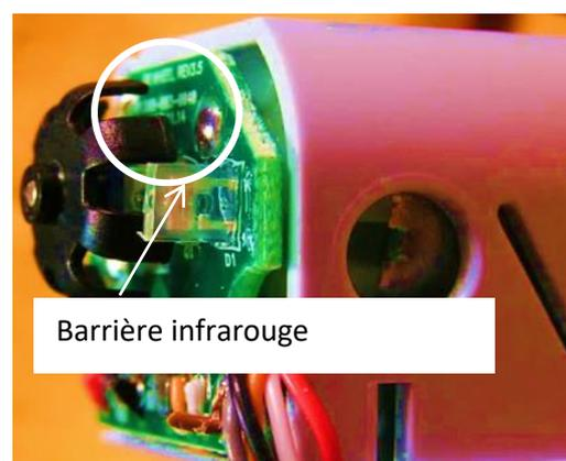
**Q1.** En utilisant les informations fournies, **calculer** le nombre d'impulsions reçues par la carte électronique du robot Scooba pour un tour de roue. **En déduire** la précision du contrôle qui est la distance parcourue pour une impulsion du codeur.
