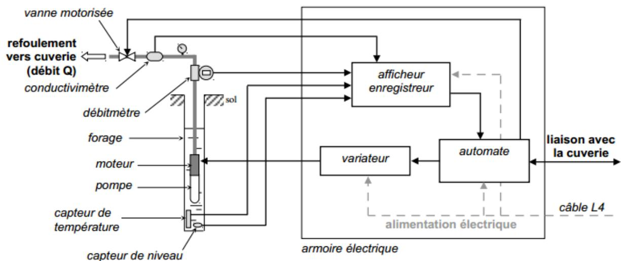
La valeur moyenne du débit  $Q$  de la pompe, fixée par les besoins en eau de l'usine, est de  $7 \text{ m}^3 \cdot \text{h}^{-1}$ . Pour s'adapter aux variations de niveau du puits L4, il peut varier entre  $Q_{\min} = 4 \text{ m}^3 \cdot \text{h}^{-1}$  et  $Q_{\max} = 10 \text{ m}^3 \cdot \text{h}^{-1}$ .
