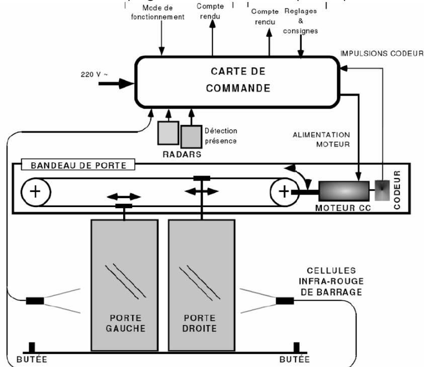
C'est un codeur incrémental qui a été choisi. Il a une résolution de 1024 points par tour. Il est directement monté sur l'axe moteur qui entraîne la poulie.
