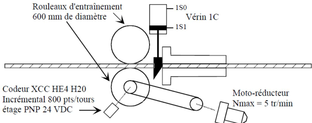
**Q1.** Compte tenu des caractéristiques du codeur, quelle sera la précision obtenue sur la longueur d'un profilé ?
