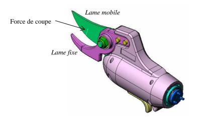
Sur la maquette numérique du mécanisme, la force de coupe a été modélisée par une force de valeur inconnue.
