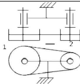
Les courroies à section circulaire, trapézoïdale, rectangulaire assurent une transmission de mouvement avec glissement. Cela peut être utilisé comme une sécurité sur certains systèmes.
