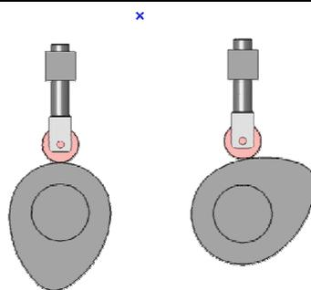
Pièce mécanique non circulaire qui a un mouvement de rotation et met en mouvement une tige. Ce système transforme un mouvement de rotation en un mouvement de translation alternatif.
