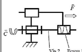
Le système vis-écrou permet de transformer un mouvement de rotation en un mouvement de translation. Ce mécanisme est, en général, **irréversible** (l'écrou ne peut pas entraîner la vis).
