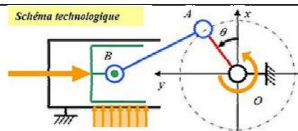
Système permettant de transformer un mouvement de translation alternatif en mouvement de rotation continu.
