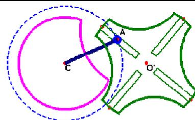
La croix de Malte est un dispositif mécanique permettant de transformer un mouvement de rotation continue en une rotation saccadée.
