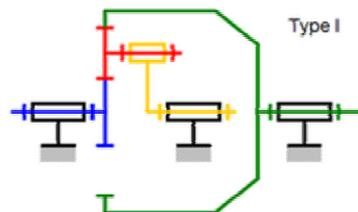
Dispositif de transmission par engrenage. Il est composé d'un planétaire, d'une couronne, de satellites (3 le plus souvent) et d'un porte satellite.
