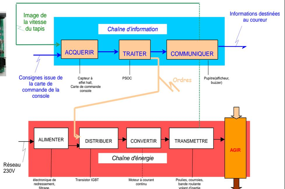
PSoC : acronyme de Programmable System on Chip, c'est la carte de commande du système
