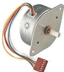
Un moteur pas à pas est un moteur qui est alimenté en courant continu. Son rotor est constitué de N pôles magnétiques (Nord et Sud). Son Stator est constitué de bobines qui sont alimentées par un circuit électronique les unes à la suite des autres pour créer des pôles nord et sud en fonction du sens d'alimentation. On trouve par exemple ce type de moteur dans les imprimantes jet d'encre pour déplacer les têtes d'impression ou entraîner le papier.
