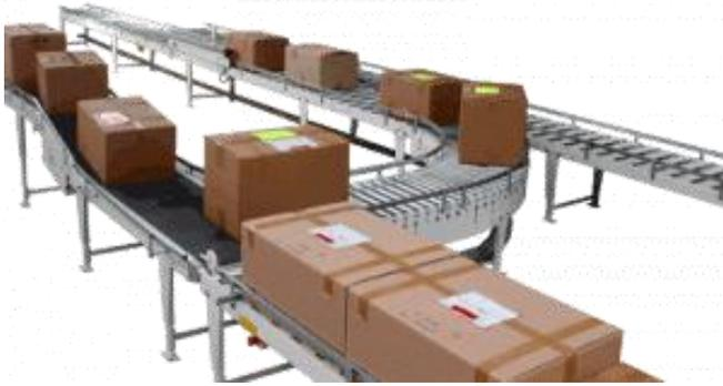
Le tapis roulant est mis en mouvement par des rouleaux de 5cm de rayon. Le rouleau qui entraîne le tapis est mis en rotation par un moteur électrique associé à un réducteur à engrenages.
