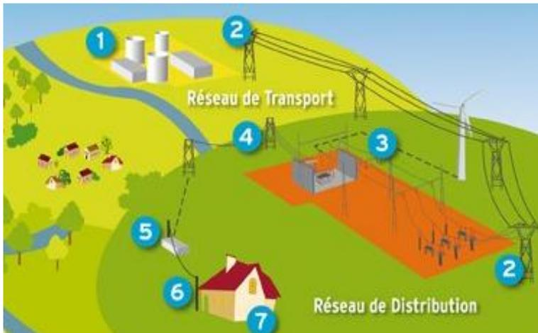
Plus la longueur des lignes est importante plus le courant perd de son énergie (pertes par effet Joules notamment). C'est la raison pour laquelle le transport sur de grandes distances se fait sous une tension élevée.
