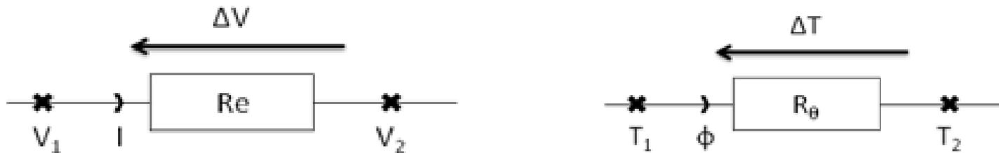
La tension est remplacée par la température
