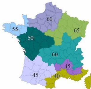
Le Cepmax est modulé selon **les émissions de gaz à effet de serre (GES)**, afin d'encourager l'utilisation des énergies les moins émettrices de CO<sub>2</sub>, à savoir le bois-énergie et les réseaux de chaleur ou de froid utilisant une part prépondérante d'énergies renouvelables (EnR).
