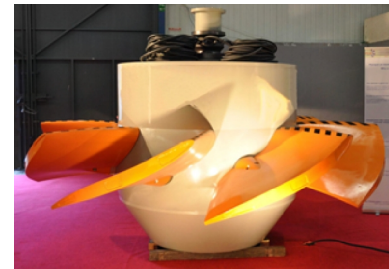
Groupe générateur d'une turbine VLH
