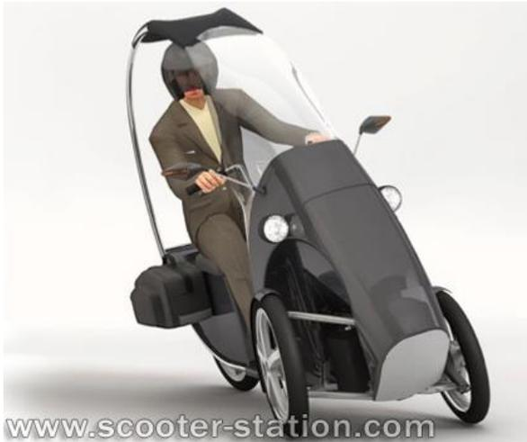
Le Tri'Ode est un véhicule électrique à trois roues. Il combine une architecture longitudinale issue des véhicules à deux roues et une architecture transversale de voiture au niveau du train avant. Ce type de disposition présente l'avantage d'être plus stable qu'un deux roues classique, d'avoir une meilleure tenue de route et une distance de freinage plus courte d'environ 20%.
