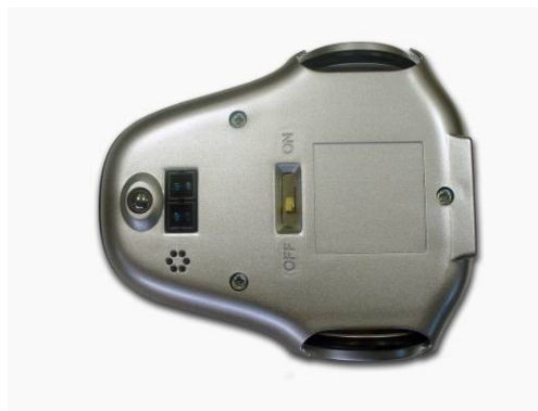
Image 10. Localisation des capteurs de ligne
