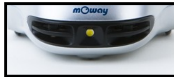
Image 12. Localisation des capteurs d'obstacles
