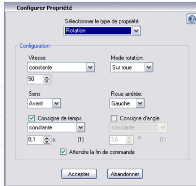
Image 34. Choisir la vitesse, le mode de rotation, le sens et le temps ou la distance
