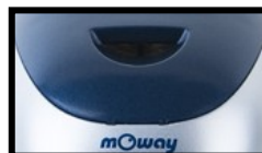
Image 13. Orifice du capteur de luminosité
