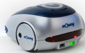
Image 16. Localisation de la DEL de frein rouge. La DEL verte allumée est le voyant de mise sous tension, elle est non contrôlable
