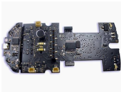
Image 5. Vue de dessus de la carte électronique mOway
