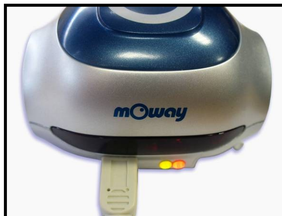
Image 17. Indicateurs de mise sous tension (vert) et de charge en cours (rouge)
