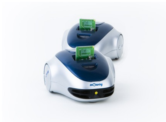
Image 14. Robots avec modules de RF sur le connecteur d'extension
