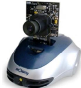
*Ce petit robot dispose de possibilités d'extensions à travers son bus de communication. On pourra y raccorder par exemple un module de communication sans fil, une caméra embarquée, une carte prototype ainsi que tout autre dispositif qui pourrait se révéler nécessaire au développement d'une nouvelle application.*
