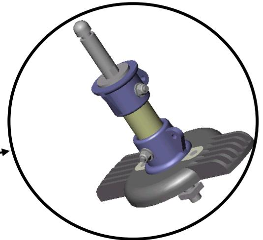
Le pied de mat permet d'établir la liaison entre le gréement et le flotteur. Cette liaison doit permettre une rotation libre au gréement par rapport au flotteur et ce, autour de tous les axes ( liaison dite « rotule » étudiée en 1ère).
