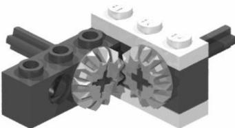
Les roues coniques ont des dents qui présentent un biais vers une surface du disque. Elle est employée lorsque deux axes se croisent suivant un angle – généralement à 90°.
