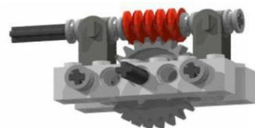
Le système roue vis sans fin permet de réduire grandement la vitesse de rotation de la roue par rapport à celle de la vis.
