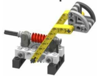
Le rendement de ce mécanisme n'est généralement pas très bon.
