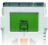
Ce menu « view » vous permet de tester vos capteurs et moteurs. Il vous permet de connaître, en temps réel, les grandeurs acquises par vos capteurs.
