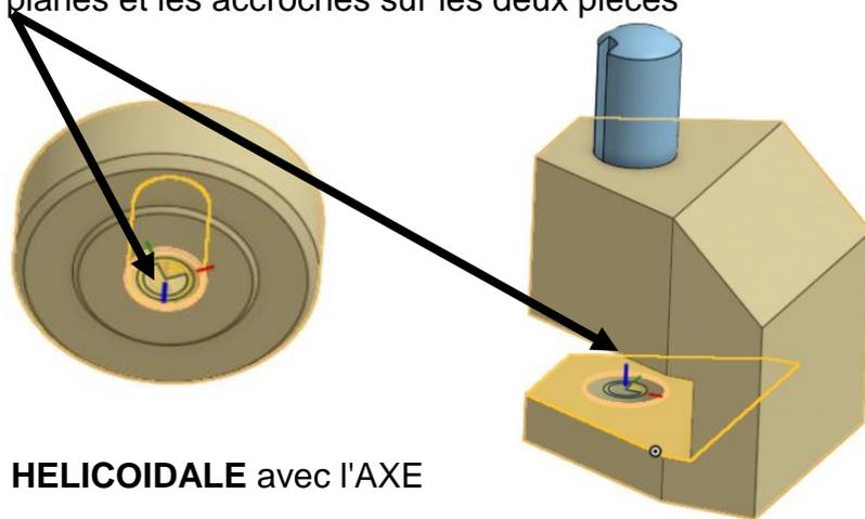
L'ECROU est en liaison **HELICOIDALE** avec l'AXE
