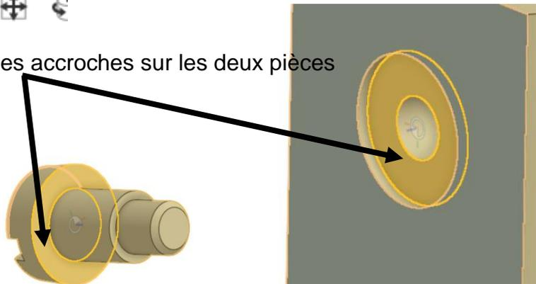
L'AXE est arrêté en rotation par l'extrémité cylindrique de la VIS.
