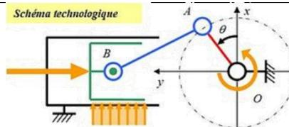
Système permettant de transformer un mouvement de translation alternatif en mouvement de rotation continu et vice versa.
