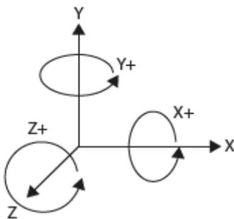
Le signe du moment algébrique dépend du sens de rotation de la pièce, provoqué par la force, autour du point considéré. Le sens trigonométrique est généralement choisi comme sens positif.
