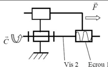
Ce mécanisme est, en général, **irréversible** (l'écrou ne peut pas entraîner la vis).
