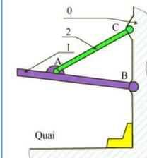
Déterminer l'intensité de la force dans la liaison pivot au point B connaissant le poids du toit et la position de son centre de gravité.
